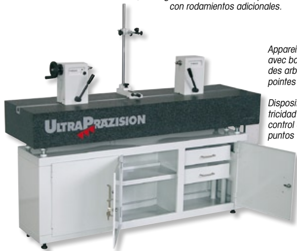
Appareil de contrôle de concentricité pour le contrôle de roulements sur des arbres, V de pré-centrage doux en plastique. La pièce est mise dans la position de mesure par un système de levage et de pose pneumatique.
