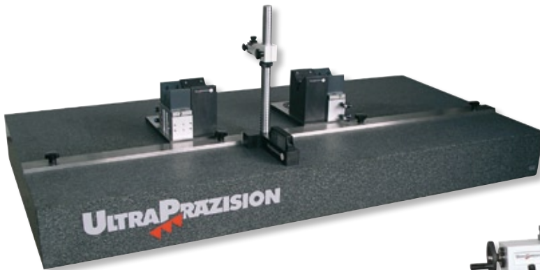
Appareil de contrôle de concentricité avec base en granit pour contrôler des arbres moteurs lourds entre pointes de centrage, la charge sera mise sur des supports avec roulements additionnels.
