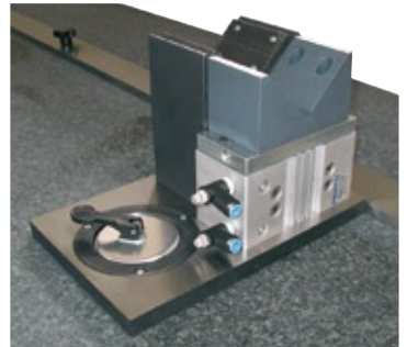
Appareil de test avec base en granit pour le contrôle de la rectitude d'axe de machines d'impression, V de pré-centrage doux en plastique. La pièce est mise dans la position de mesure par un système de levage et de pose pneumatique.
