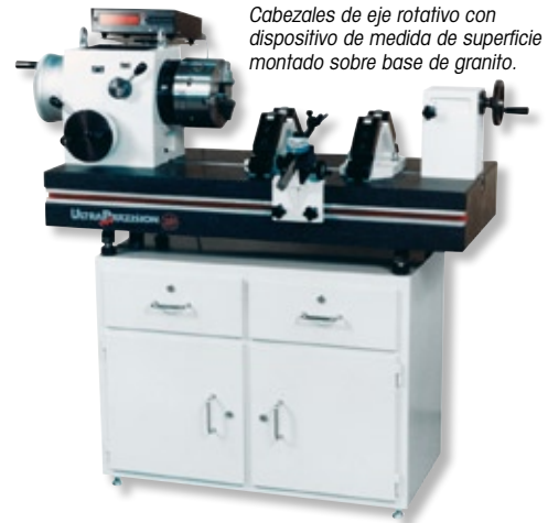
Poupées à axe rotatif avec appareil de mesure de surface monté sur base en granit.
