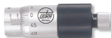
Lecture 0,005 mm, pas de vis micrométrique 0,5 mm (100 graduations tracées sur le tambour)
