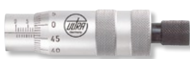
Lecture 0,01 mm, pas de vis micrométrique 0,5 mm (50 graduations tracées sur le tambour)
