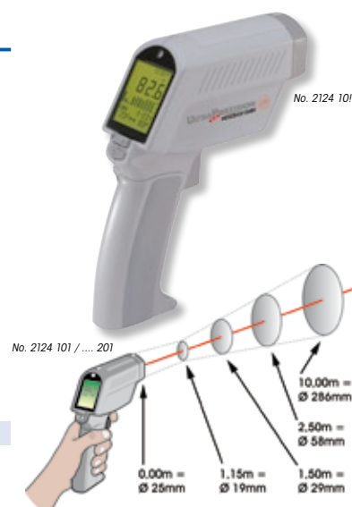
Optique standard 60:1 Point de mesure Ø 19 mm à 1,15 m Point de mesure Ø 286 mm à 10 m
