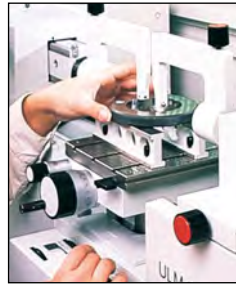
Prüfung eines Einstellings Calibration of setting ring gauge
