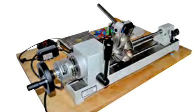
LASER Messvorrichtung für Turbinenschaufeln LASER measuring system for turbine wheels
