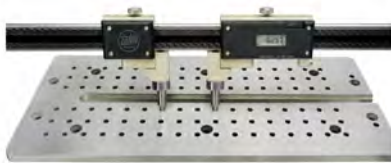
Anwendungsbeispiel Bohrungsabstand messen Example of use bore distance measurement
